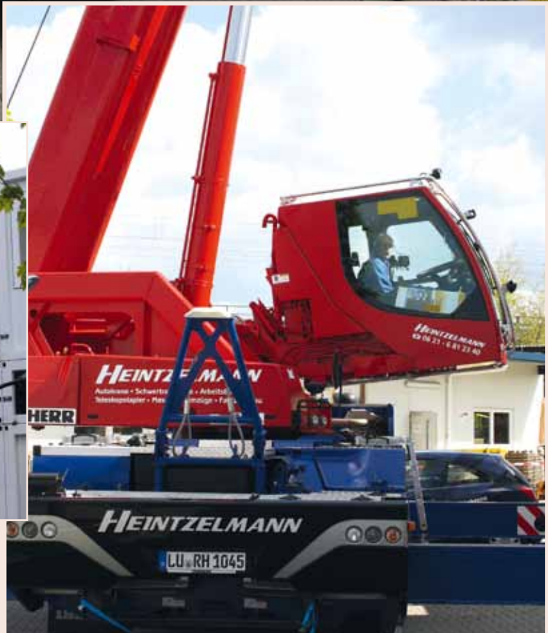
Hochvariables Kabinenkonzept: In „Normalstellung, gekippt und hochgefahren.
